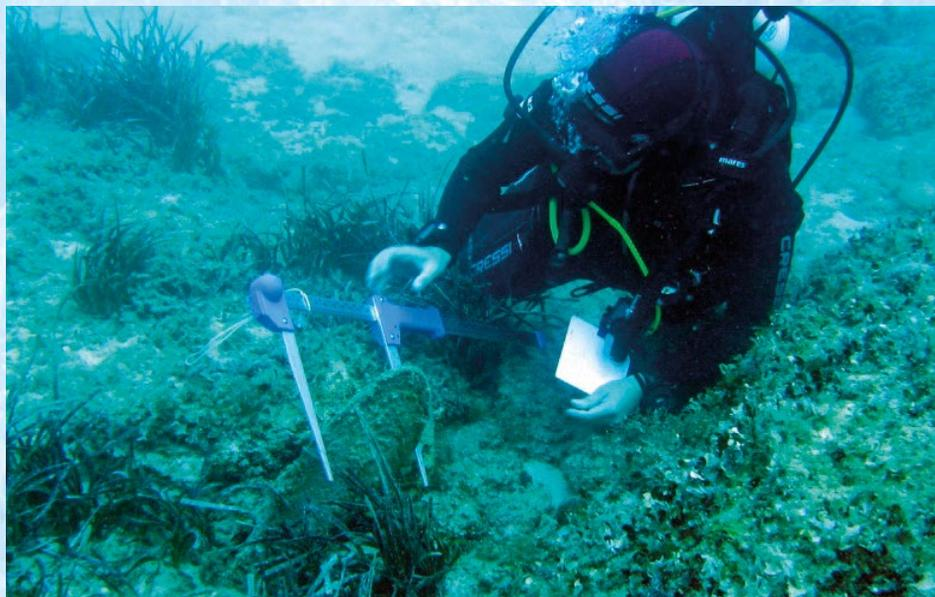
Misurazione della larghezza delle valve di *Pinna nobilis* mediante appositi calibri. La lunghezza totale della conchiglia viene poi stimata mediante un algoritmo.
